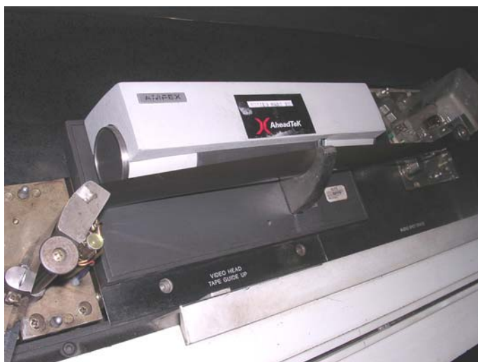
Figura 131: Registro Transversal Cabezal de un magnetoscopio Ampex AVR-1 de 2 pulgadas. (Imagen cedida por el Centro de Documentación de RTVE)
