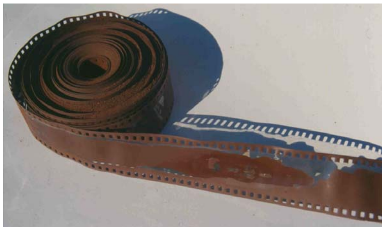
Figura 060 Película perforada magnética con soporte de triacetato, severamente dañada por el síndrome de vinagre.
