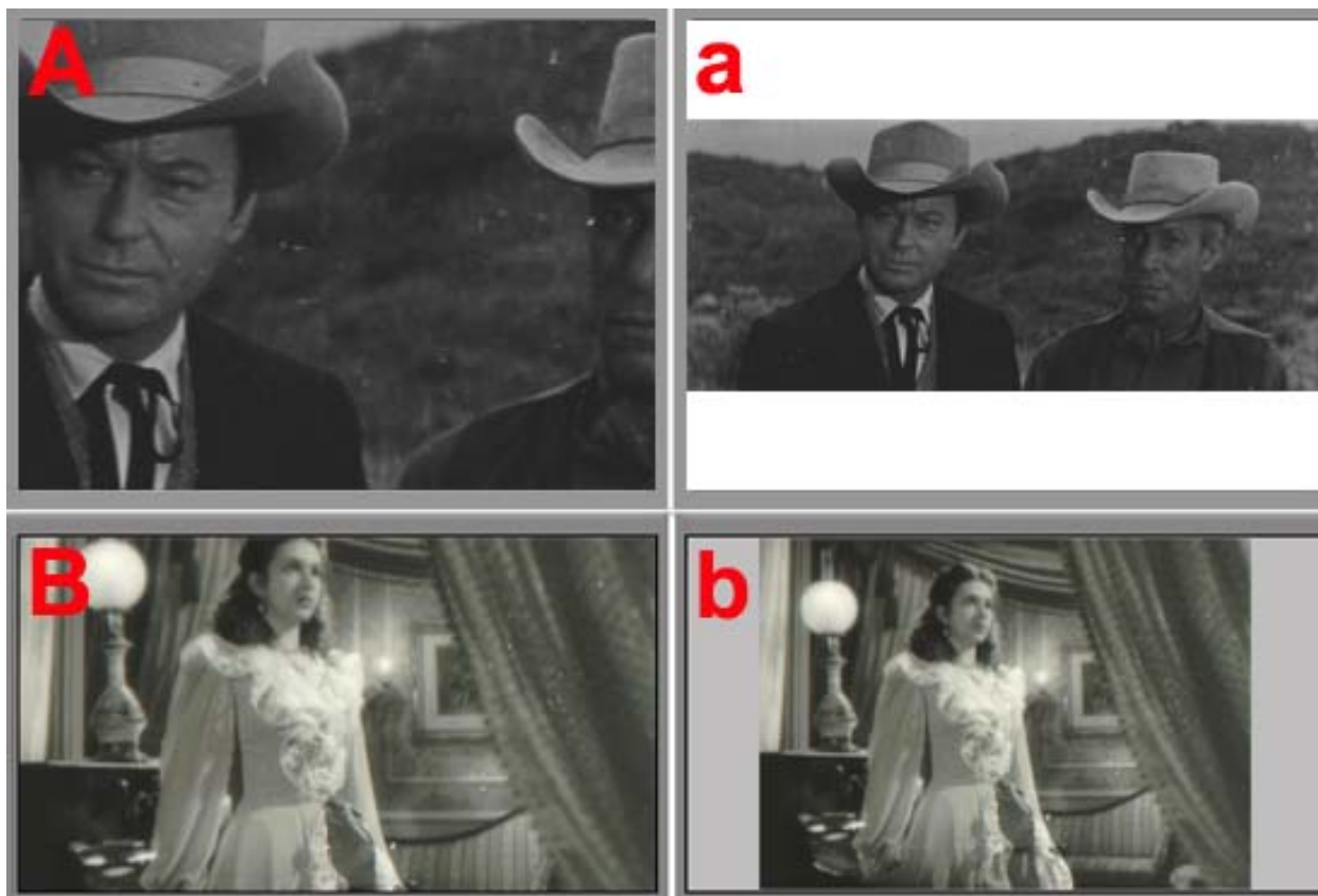
Figura 113 - Adaptaciones de formato para TV Adaptaciones de scope a pantalla 4/3 y de 1:1'37 a pantalla 16/9: [A-B] Utilizando toda la superficie de la pantalla, [a-b] Dejando dos bandas vacías.
