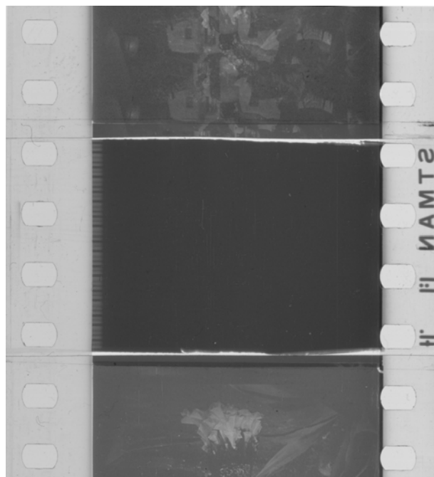
Figura 156 Fotograma empalmado en un negativo de imagen para corregir la sincronización con el sonido.
