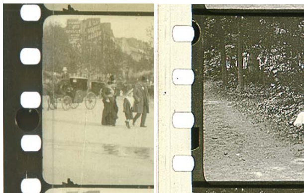
Figura 76 Reproducción de negativos con perforación Lumière sobre películas con perforación Edison
