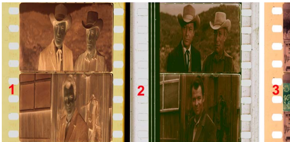
Figura 104 [1] Dup-negativo de una película filmada en Scope Super 35 y encuadrada para Scope estándar. [2] Copia Scope. [3] (En verde) Código marcado por el montador de negativo sobre el área de imagen correspondiente a la reserva de sonido.
