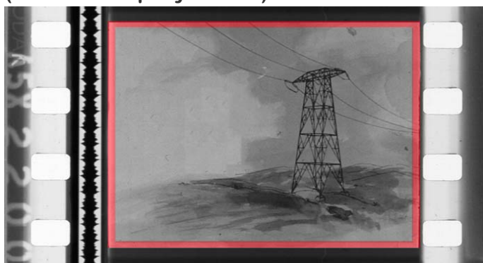
Figura 96 - Esquema de la zona de seguridad en formato 1:1'37 (según normas ISO). Área de imagen filmada: 21'95/16'00. Área de imagen proyectada: 21'11/15'29.
