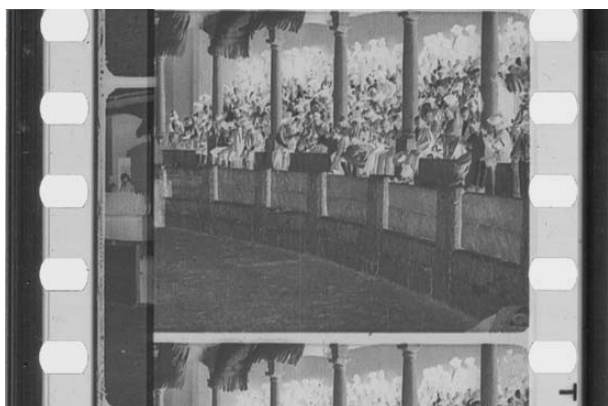
Figura 110 Duplicado negativo de una copia muda, obtenido en una copiadora sonora de contacto en los años 50.
