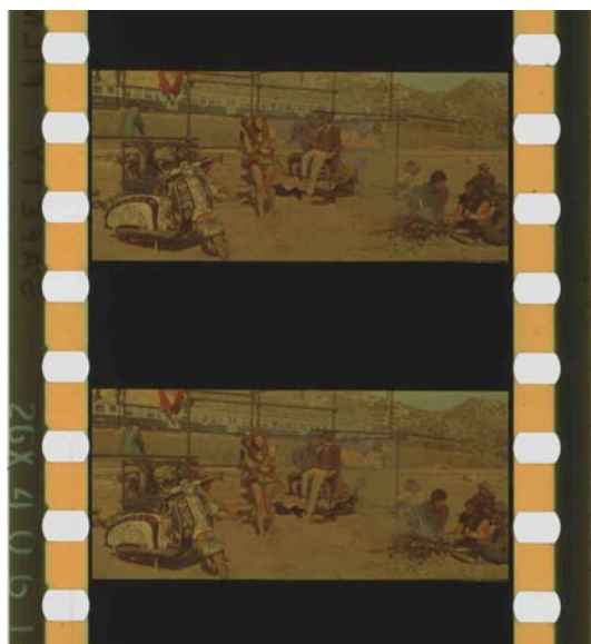
Figura 48 - Duplicado positivo Eastman Color Intermediate con enmascarado integral.
