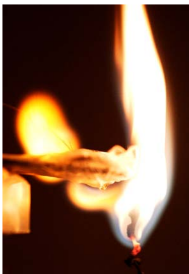
Figura 68 - Muestras de nitrato (izquierda) y triacetato ardiendo simultáneamente.
