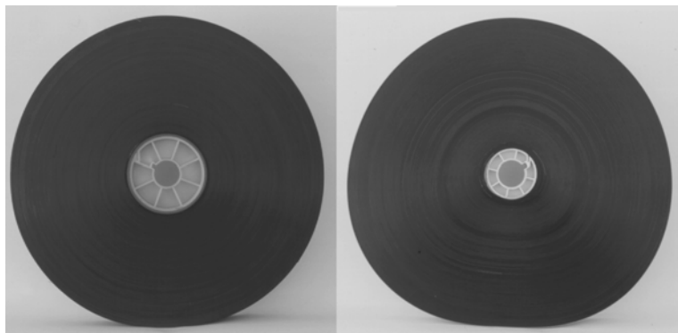
Figura 178 Películas con enrollado para transporte y para almacenamiento. (Fotografías: Diego Martín)
