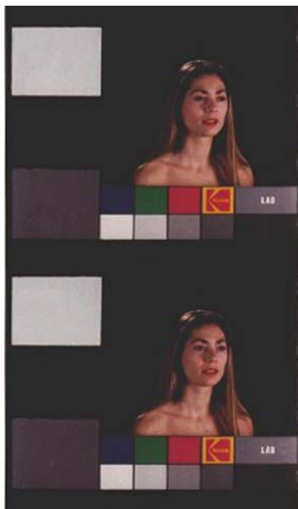
Figura 57 - Las tiras de control LAD, incorporadas a los negativos y reproducidas en las copias, pueden proporcionar una información fiable sobre las características de reproducción y procesado de cada material
