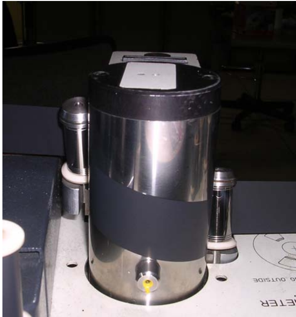
Figura 132: Registro Helicoidal. Cabezal de un magnetoscopio Bosch BCN-51. (Imagen cedida por el Centro de Documentación de RTVE)
