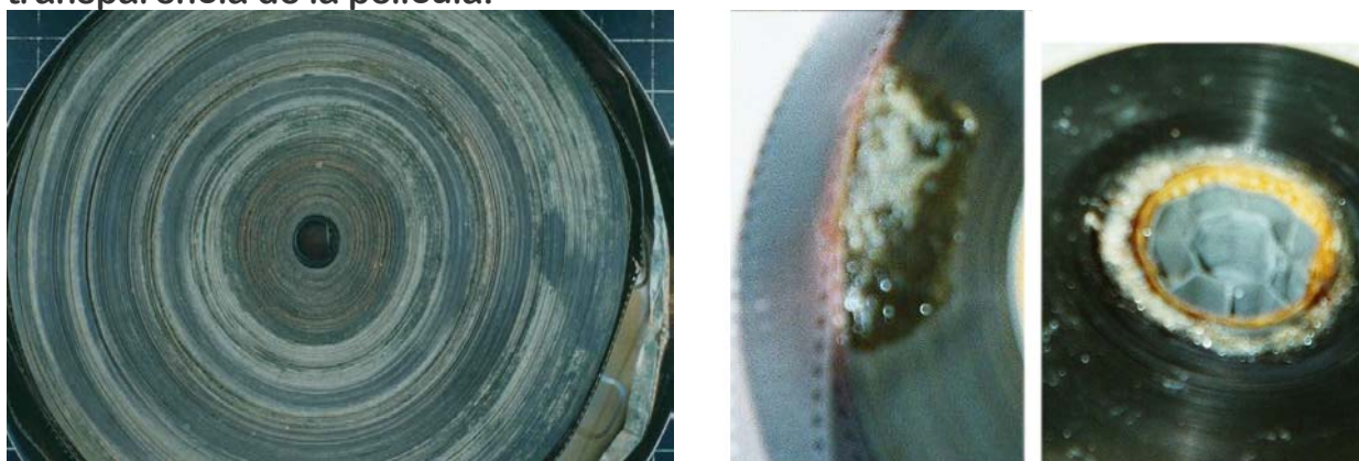
Figuras 10 y 11: Rollos en fase de cristalización y en las últimas fases de la degradación
