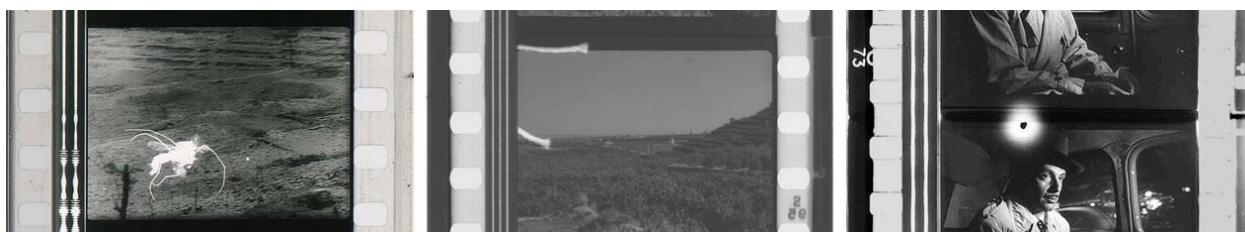
Figura 160b: Defectos de reproducción [1] Mosquito en el negativo. [2] Hilo en el negativo. [3] Defecto de secado en el negativo.
