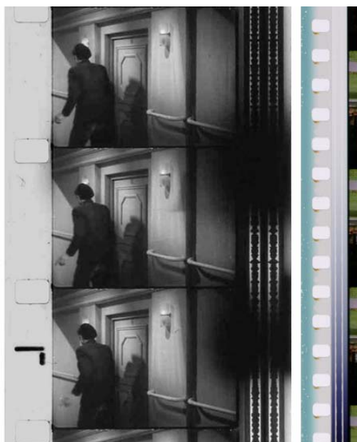
Figura 160a Defectos de reproducción [1] Entrada de luz en positivo. [2] Fallo de la lámpara de sonido en negativo.
