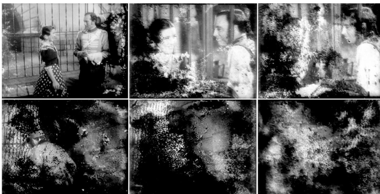
Figura 6: Avance de la descomposición en los tres últimos planos de un rollo
