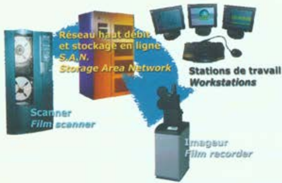
Figure 1 : Chaîne de traitement numérique du film
