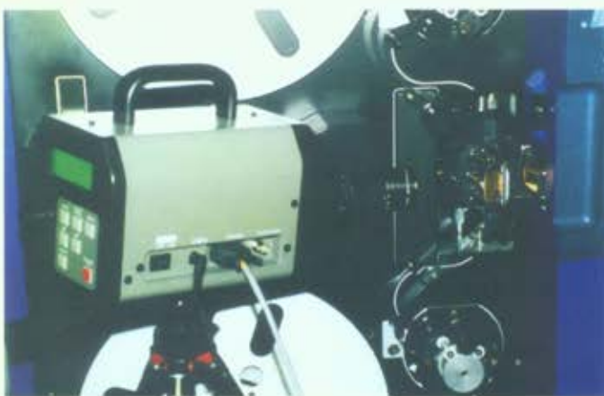
Figure 3 : Mesure spectrales de la lampe et des filtres primaires du scanner Klone de Cintel à l'aide d'un thermocolorimètre Minolta
